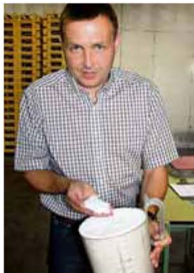
Kügelchen werden mit Wasserdampf aufgeschäumt und in die gewünschte Form gebracht. Der geringe Materialeinsatz ist ein Vorteil der EPS-Verpackungen.
